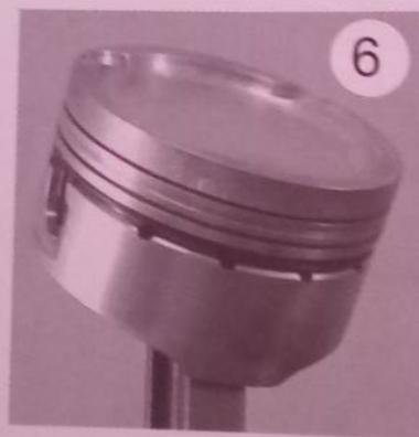
**Figura 2.19 - Tipi di pistone:** 1. a cielo piatto; 2. con camera di combustione a cuspide; 3. con incavi per le valvole; 4. con camera di combustione emisferica; 5. con gobba e cave per le valvole; 6. con camera di combustione cilindrica e cave per le valvole.
