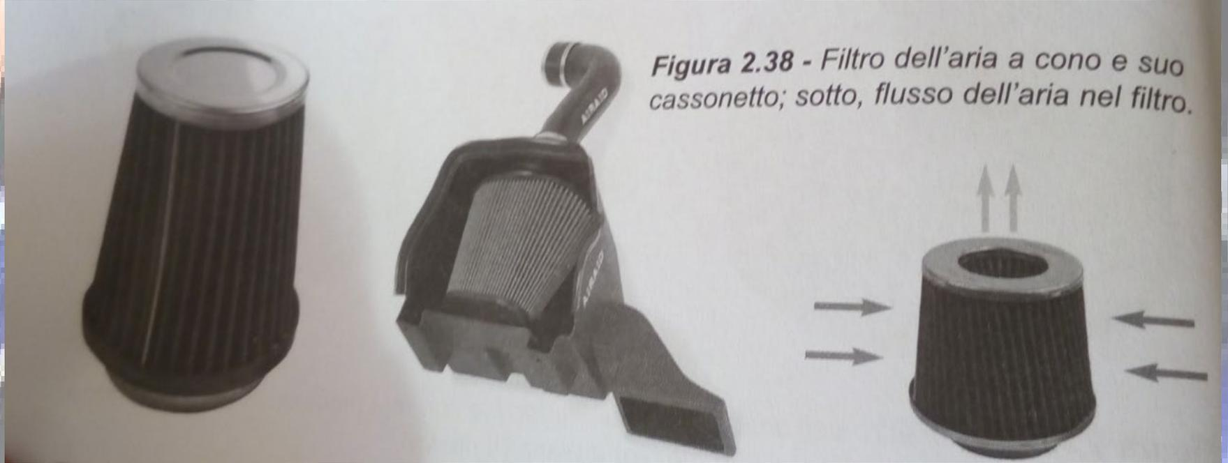
*Figura 2.38 - Filtro dell'aria a cono e suo cassonetto; sotto, flusso dell'aria nel filtro.*
