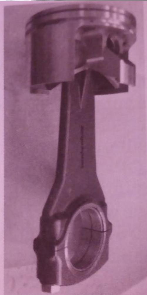
**Figura 2.21 - Gruppo pistone-biella: il piede di biella è diviso in due parti per consentire il montaggio sull'albero motore.**
